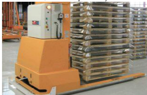
Сурет 3 – MSK таңбалы айырлы тиеуішімен электрлі AGV
