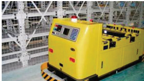
Сурет 1 – AGV технологиясының негізі – автоматты басқарылатын арба
