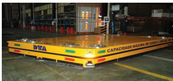
Сурет 2 – AGV типтік түрі – тиегіш арба
