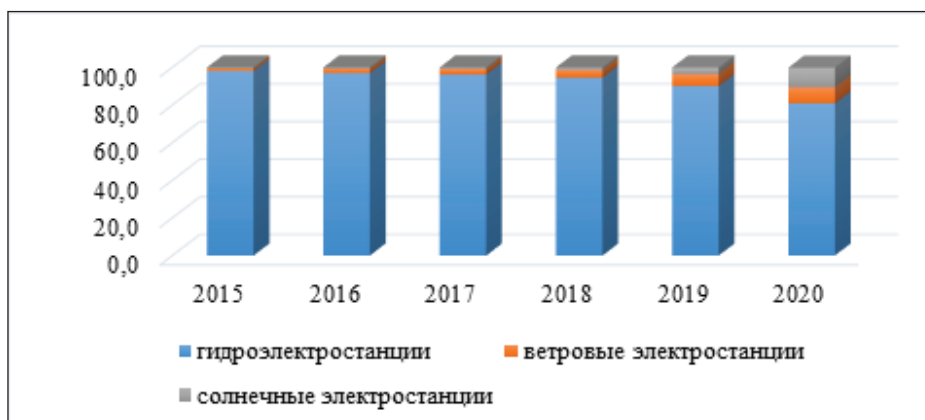
Рисунок 2 – Динамика изменения доли ВИЭ по видам от общего объема электроэнергии, выработанной ВИЭ
